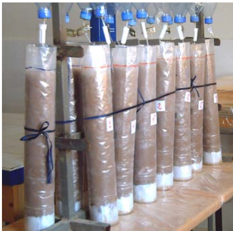
Photo II.1 : Essai expérimental en colonne (a : l'eau du forage utilisée en irrigation, b : parcelle échantillonnée, c : colonnes de sol réalisées).
